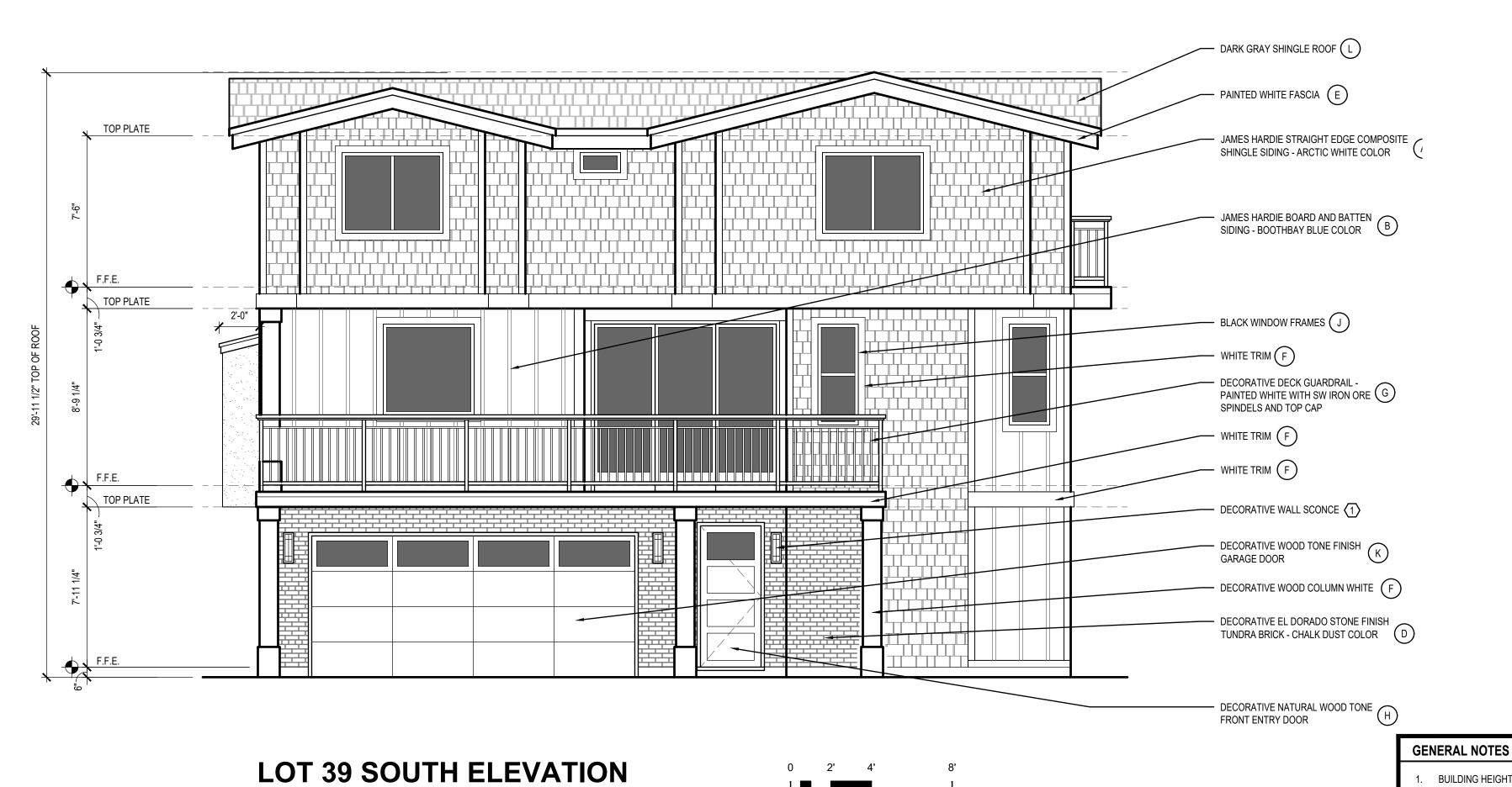
— DARK GRAY SHINGLE ROOF L — PAINTED WHITE FASCIA (E) TOP PLATE - JAMES HARDIE STRAIGHT EDGE COMPOSITE SHINGLE SIDING - ARCTIC WHITE COLOR DECORATIVE DECK GUARDRAIL PAINTED WHITE WITH SW IRON ORE
